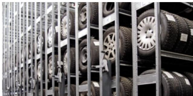
Специально разработанные полочные стеллажи, установленные на передвижных платформах, станут оптимальным решением для хранения шин. Проходы могут быть созданы внутри полочной стеллажной системы для доступа к необходимым товарам
